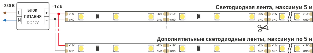
Схема 1. Подключение нескольких светодиодных лент с одной стороны.
